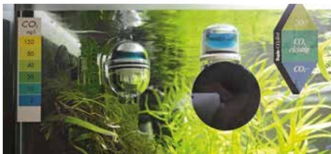
Dupla- und Dennerle-Test bei einer CO<sub>2</sub>-Konzentration von fünf Milligramm pro Liter
