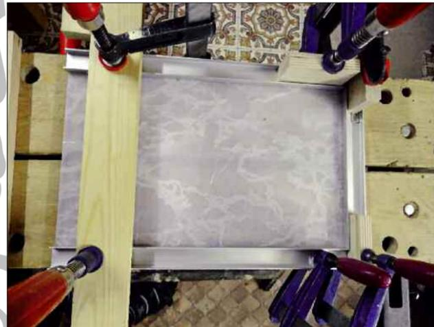
Der Kabelschacht aus Alu-U-Profilen, die mit Flachwinkeln verbunden wurden (hier beim Verkleben). Foto: P. Fitz
