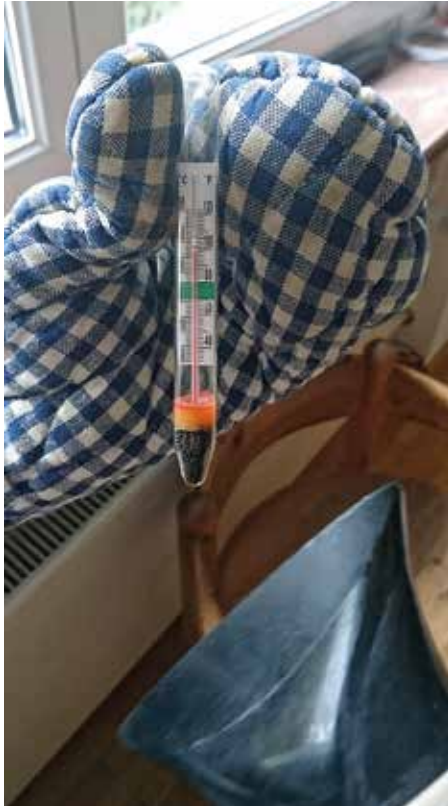
Klarer Fall, der Faden ist gerissen. Die „Reparatur“ gelingt mittels Fön und Backhandschuh.
