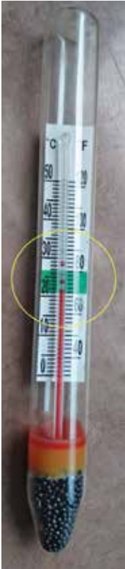
Klarer Fall, der Faden ist gerissen. Die „Reparatur“ gelingt mittels Fön und Backhandschuh.
