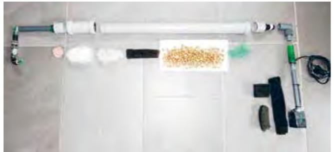
Übersicht über Aufbau und Bestückung des Filters
