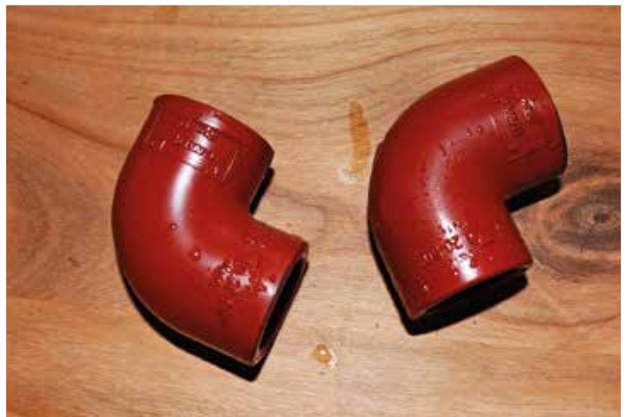
Stutzen nach der Behandlung mit Wasserstoffperoxid und Essigsäure – wie neu!
