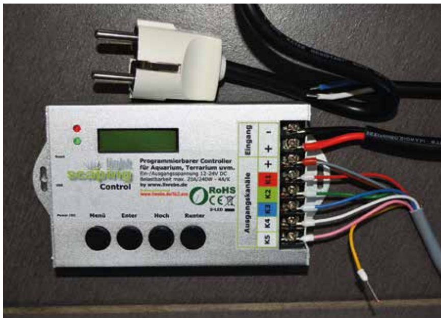
Anschluss von Netzteil und „Scaping light Biotop“ an den Controller – ein Kabel (orange) blieb übrig
