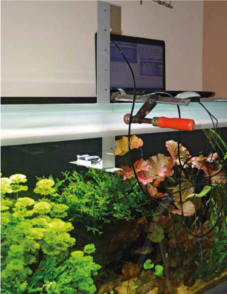
Messanordnung zur Bestimmung der Beleuchtungsstärke verschiedener LED-Balken
