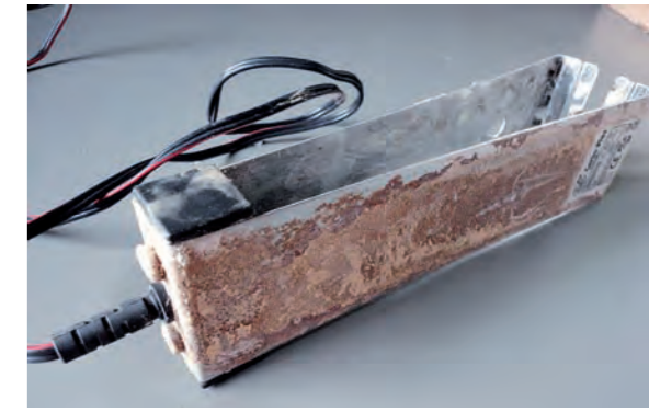
Carbon-Sandwich-Gehäuse nach der Reinigung
